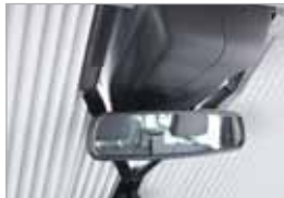
Frontteil mit Sensorpaket und mit Ablage ab 2019/07
