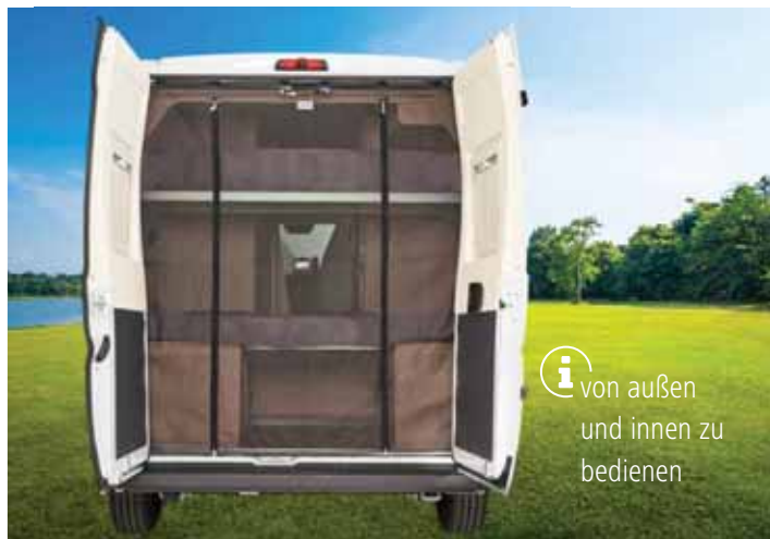
Dreiseitig perfekt dichter Abschluss mit Magnetbefestigung
