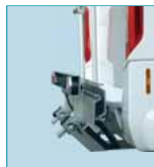
Fahrzeug mit hochgeklapptem Träger ca. 40 cm kürzer
