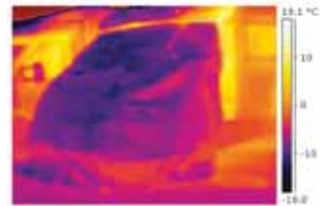
Je heller die Fläche, umso größer ist der Wärmeverlust.
