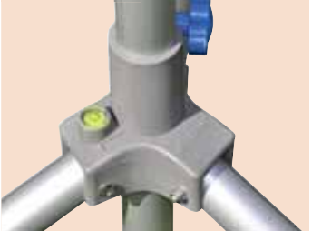
Das Sat-Stativ ist mit einer Wasserwaage am Südbein ausgestattet.
